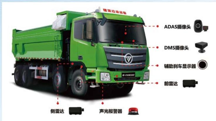
特种车辆盲区主动安全系统是在车辆低速行驶过程中（15km/h 以下），通过两个 77G 毫米波雷达探测车辆起步和右转弯盲区危险，在与骑行者发生接触前，系统主动刹车降低车速，将碰撞骑行者的风险减至最低或减轻碰撞伤害程度的一款智能安全装置。
