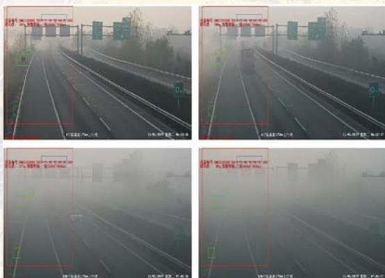
宁洛高速安徽段建设使用超远信息视频能见度检测器，对监控视场内发生的能见度进行自动检测并报警
