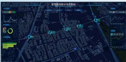
智慧路网数字孪生系统应用 AI 智能感知设备对机动车、非机动车、行人等交通要素实现全时空捕获，结合数字孪生技术为用户提供数字化全息视角，将实时交通流呈现在一个可视化的模型中，真正做到全路段全局可见，即“上帝视角”，为交管部门提高路网管理效能提供数据基础和决策支持；应用大量的数据分析模型实现对城市道路交通态势实时感知、布控车辆实时预警、信号控制实时
