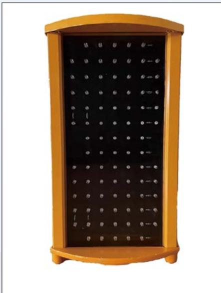
行车诱导装置主要应用在雨、雪、雾等低能见度因素影响的路段以及桥梁、弯道等事故多发路段。装置采用一体化设计，集成嵌入式控制、车辆检测、主动发光、无线自组网、太阳能供电等技术。装置安装于公路两侧护栏上以红、黄警示灯交替闪烁提醒司机控制车距、减速慢行。同时配套的天气现象检测仪可实时监测公路能见度变化，根据能见度等级，自动启动行车诱导装置进行行车诱导。行车诱导具有道路轮廓强化、行车主动诱导、防止追尾预警等多种功能，其发出的红、黄光语信号等帮助驾驶人员判断前方道路状况和前方车辆状况，为驾乘人员提供清晰的诱导路线，从而避免危险路段车辆追尾事故、二次事故，特别是恶劣天气影响下的连环撞车等恶性事故的发生。
