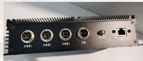
产品配备多个传感器接入、电源、GPS 和网络接口
