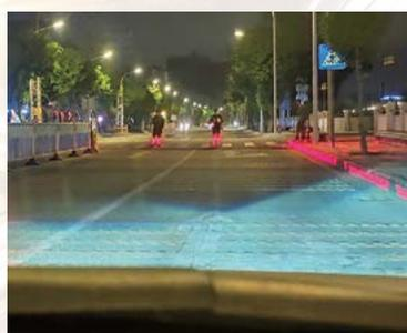
司机视角，离斑马线 100 米外就可看到反射的红色光线，及时减速制动
