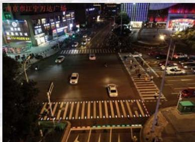
灯控路口——斑马线行人驻足区发光地砖与人行灯色同步，斑马线间隙镶嵌白色发光地砖形成流水灯，机动车停
