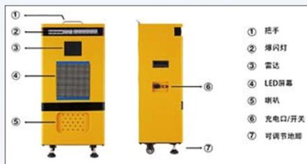
必安仕智能防闯入主动预警装置实时跟踪封闭作业区域前方 300 米范围内所有行驶车辆轨迹，采用二级报警机制。在远距离报警区域，当监控的车辆目标出现车速过快，S 型行驶，频繁换道等驾驶行为，触发一级报警，开启高音喇叭报警声，提醒该车司机注意前方施工危险。在近距离报警区域，当监控到速度大于 35 公里 / 小时的车辆，超过一个时间阈值（可自行设置）会撞向封闭作业区域，触发二级报警，向作业人员佩戴的智能手环发出振
